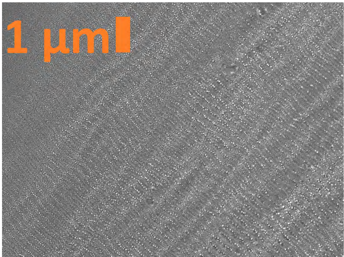
Abbildung 51: Nahaufnahme des mit einer Energie von 103 \mu\text{J} laserbehandelten Einzelspots
